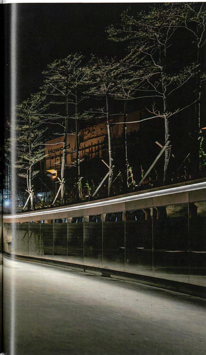
地下道採用鏡面不鏽鋼，營造寬敞空間。
